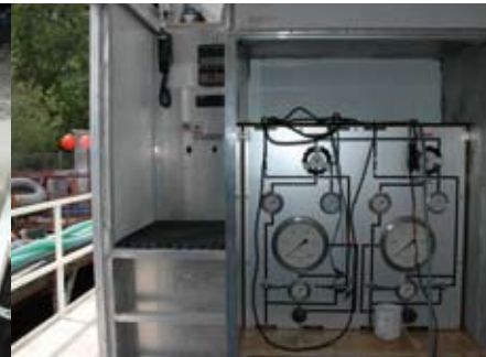
Bateau équipé de deux narguilés de 50 m et tableau de contrôle avec communication
